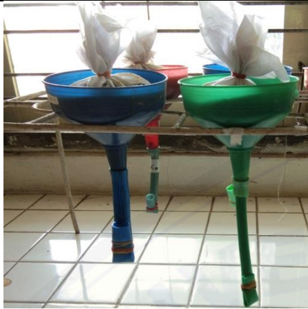
Gambar 1. Alat-alat ekstraksi tanah dengan metode Baermann modifikasi
