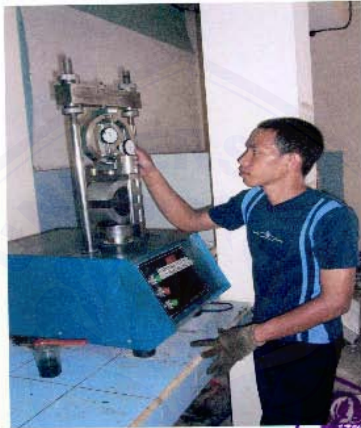
Gambar B.6 Pengujian Benda Uji dengan alat Marshall
