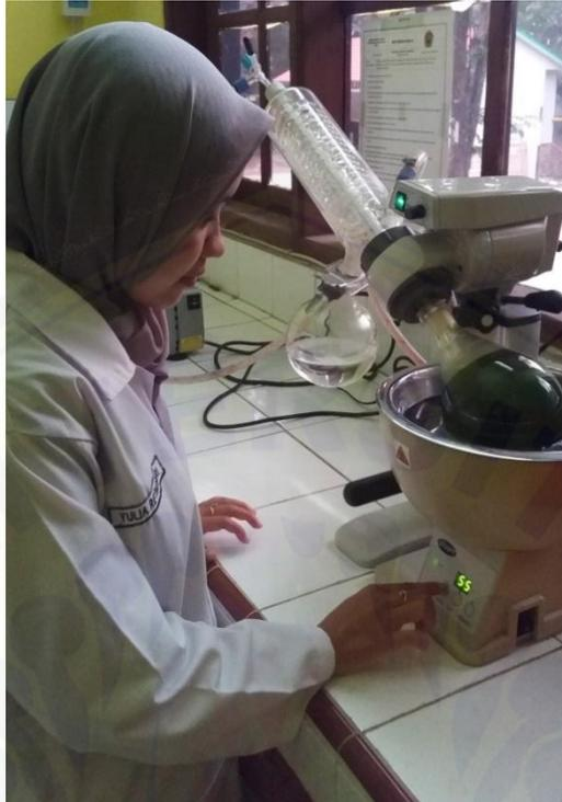
Gambar F.3 Proses pemisahan ekstrak menggunakan *rotary evaporator*
