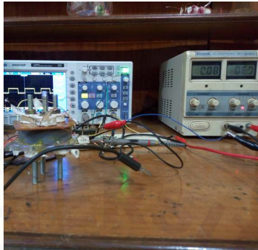
Gambar 6. Pengukuran Arus dan Frekuensi Pada Tegangan 6 Volt
