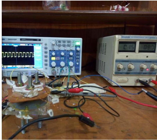
Gambar 9 Pengukuran Arus dan Frekuensi Pada Tegangan 9 Volt
