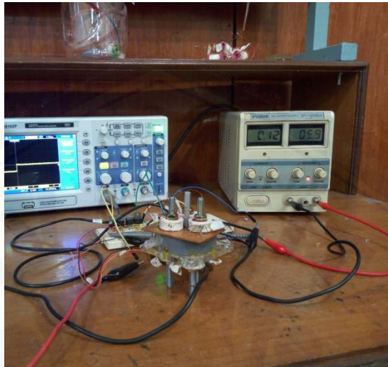
Gambar 1. Pengukuran Arus dan Frekuensi Pada Tegangan 6 Volt
