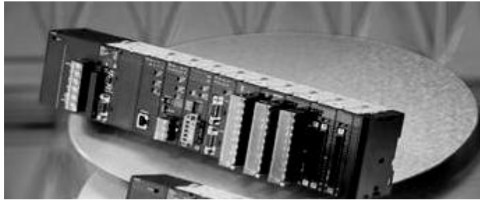
Gambar 2.4 PLC modular dari Omron (OMRON, 2004)
