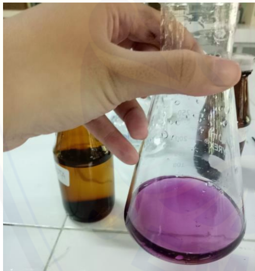
Penambahan larutan EBT ke dalam sampel air
