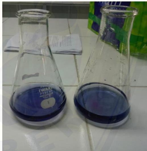
Hasil akhir uji kesadahan air menggunakan metode titrasi
