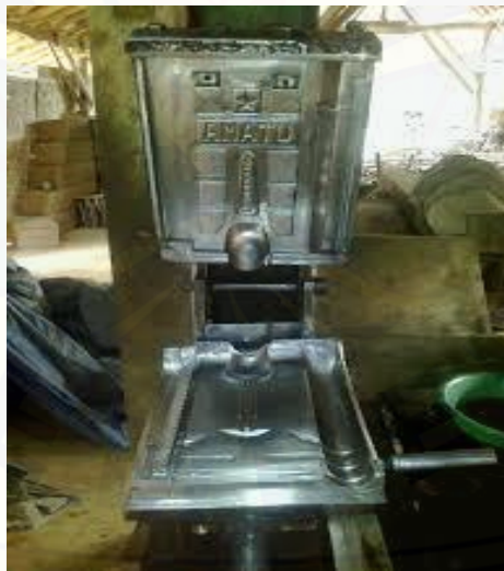
Gambar 2.7 Cetakan Manual Genteng Kodok
