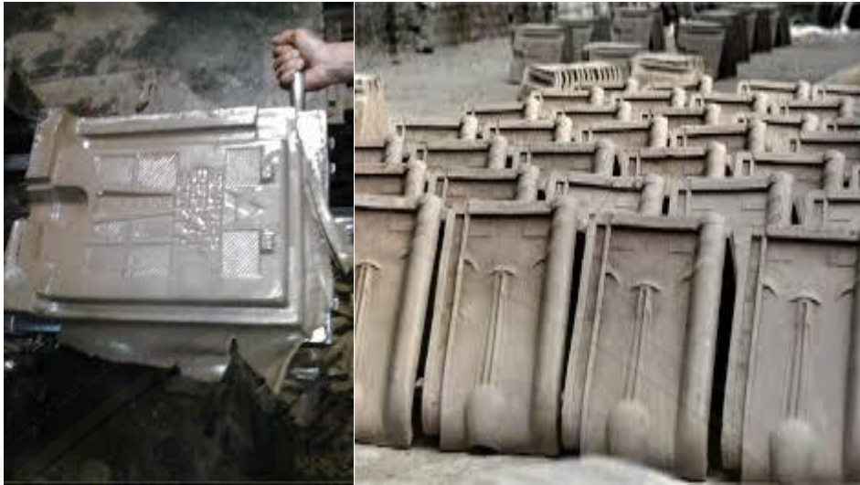
Gambar 2.8 Hasil Pencetakan Genteng Kodok
