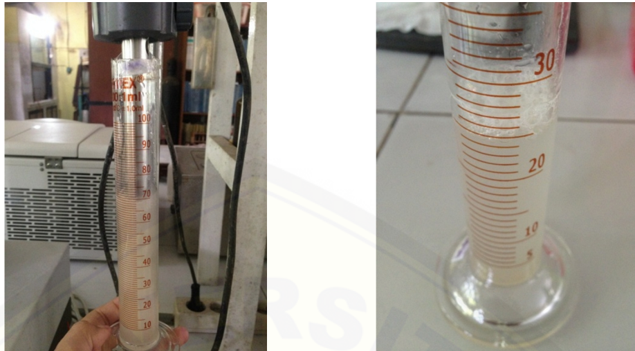
Pengujian Daya Buih dan Stabilitas Buih
