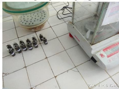
Gambar 6.14 Pengukuran kadar air pakan sapi
