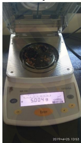
Gambar 6.17 Pengukuran kadar air kulit kopi
