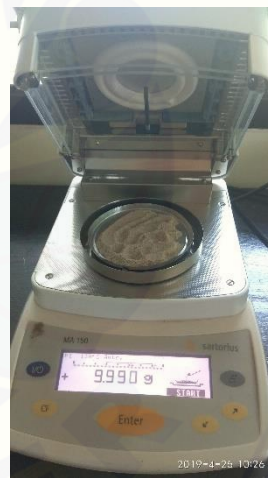
Gambar 6.12 Pengukuran kadar air tepung tulang sapi
