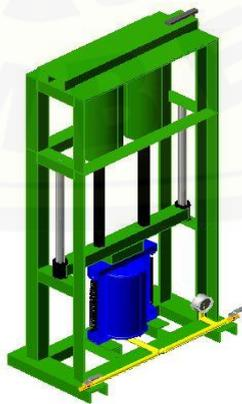
Gambar 3.3 Desain alat pencetak kompos blok setelah modifikasi
