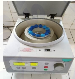
Pemisahan supernatan dengan sentrifuse kecepatan 2500 rpm, 15 menit
