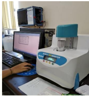
Pemasangan Canister pada RVA dan Pengaturan Kecepatan Putaran Hingga Konstan
