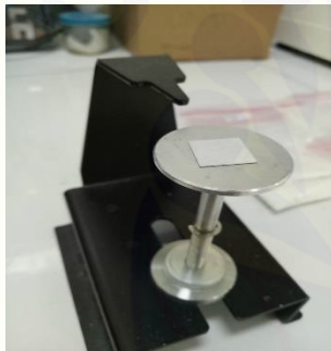
Pemasangan Carbontip pada Lempeng
