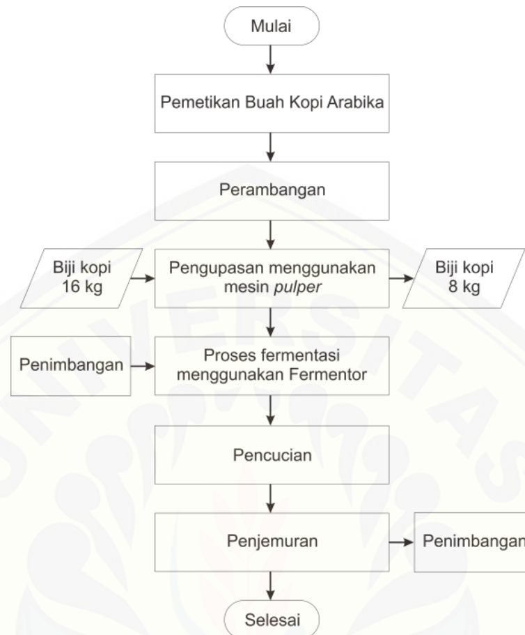
Gambar 3.4 Diagram alir mekanisme proses fermentasi kopi dalam fermentor
