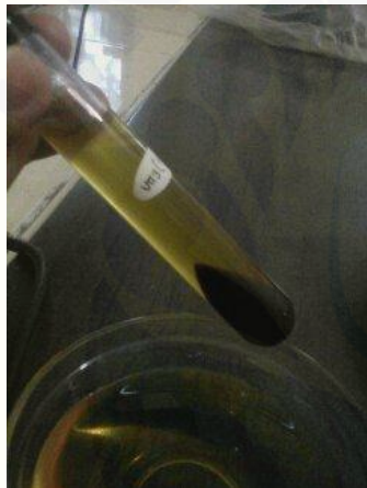
Gambar 27. Hasil sampel DSM setelah proses sentrifuse
