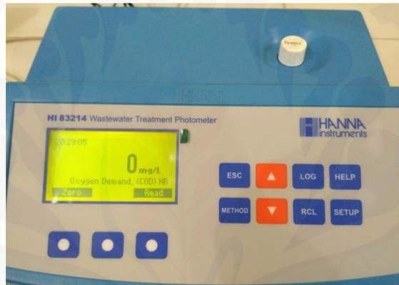
Pengukuran COD dengan Spektrofotometer
