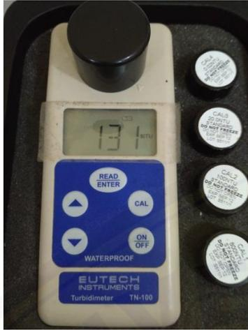
Pengukuran kekeruhan dengan turbidimeter
