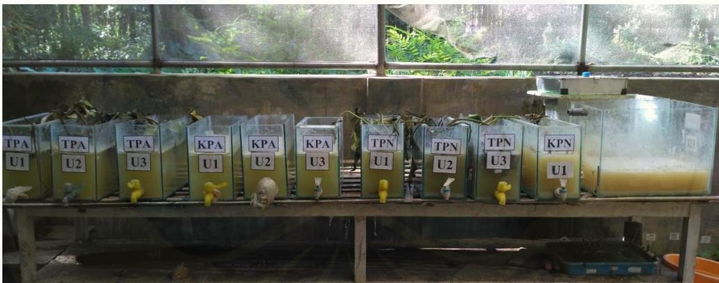
Proses fitoremediasi limbah cair pembuatan tempe pada hari kedelapan
