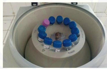
Proses Sentrifus untuk mengambil filtrat
