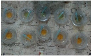
Proses pengukuran alkohol metode conway
