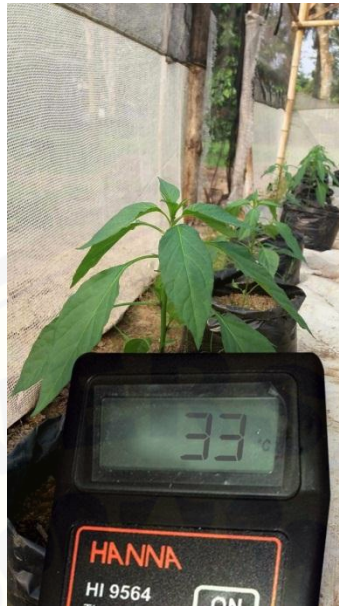
Gambar 2.8 pengecekn suhu Greenhouse dengan Termohigrometer .
