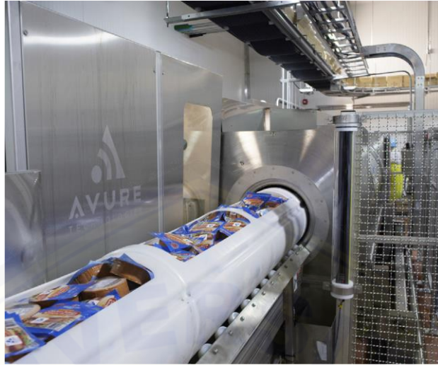
Gambar 2.4 Mesin HHP horizontal untuk pengawetan daging kemasan (Sumber: Patterson, 2014)
