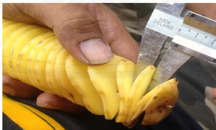
Pengukuran ketebalan pada bahan (ujung akhir)
