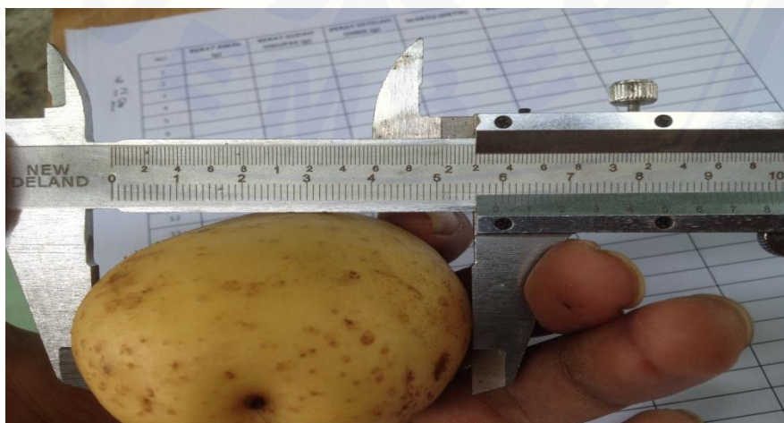
Pengukuran diameter bahan
