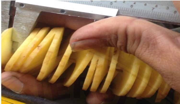
Pengukuran ketebalan pada bahan (ujung awal)
