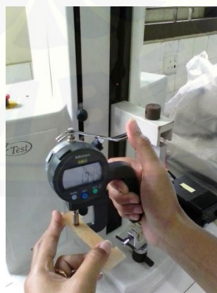
Pengukuran ketebalan untuk uji kuat tarik
