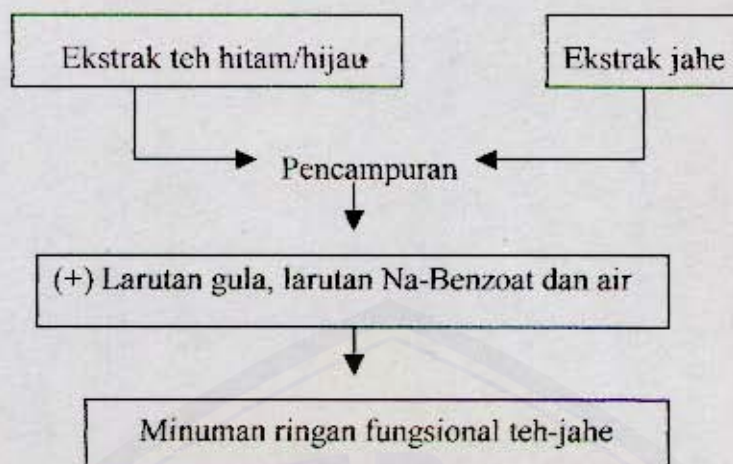
Gambar 6. Diagram Alir Pembuatan Minuman Ringan Fungsional Teh-Jahe
