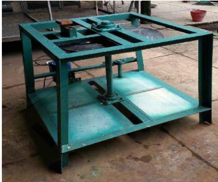
Gambar 2.6 Mesin Pengiris Pisang Tipe Rotari (Horizontal) (skala 1 : 7)
