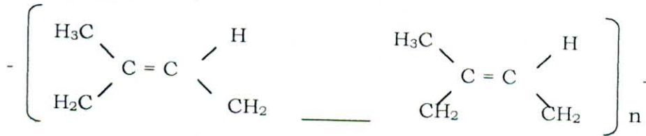
Gambar 1. Struktur ruang 1,4 cis polyisoprene karet alam Morton, 1969 (dalam Gautara dkk., 1985).
