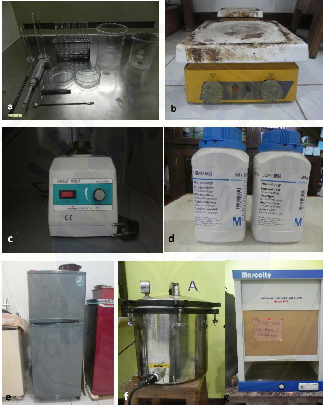
Gambar D.3 Alat yang digunakan; a) Peralatan gelas (Gelas ukur 100ml dan 50 ml, cawan petri, ose, tabung reaksi, sumuran, spatula, dan dan mikropipet) b) penangas, c) vortex, d) Medium NA dan NB, e) Kulkas, f), Autoclave) g) Laminar Air Flow
