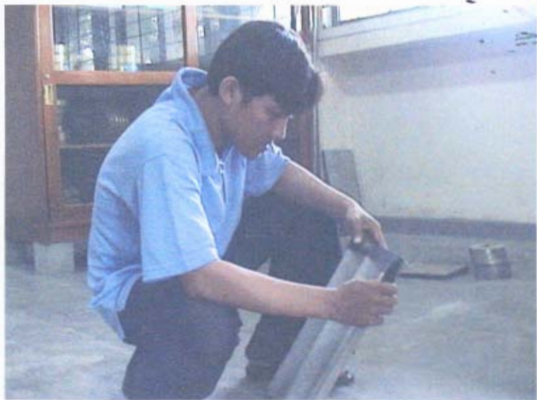
Pengukuran Benda Uji Genteng Beton
