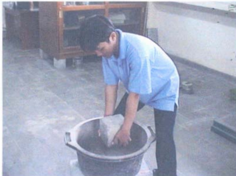
Pemasangan Beban Pada Uji Kuat Lentur
