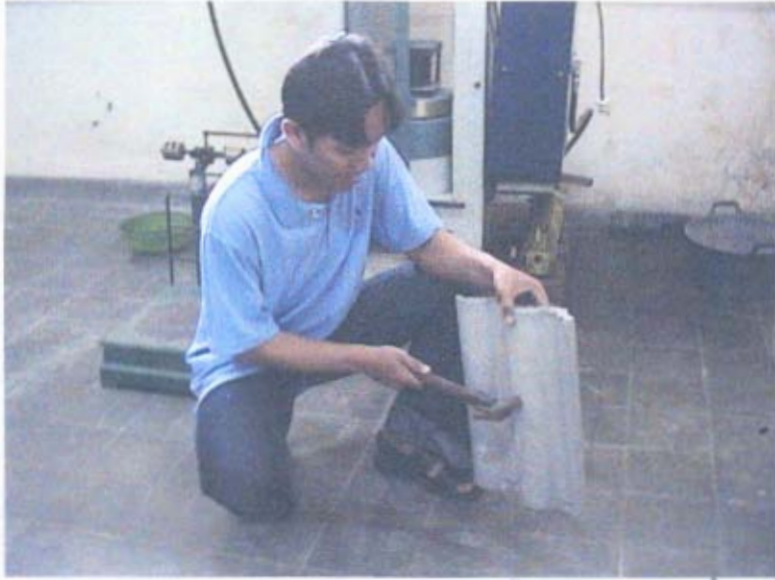
Pengujian Bunyi Pada Genteng Beton
