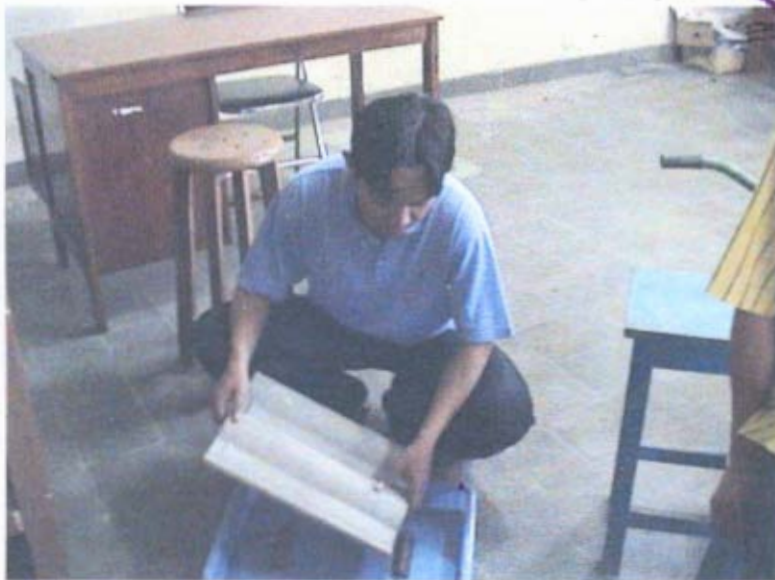
Pengujian Daya Resap Pada Genteng Beton
