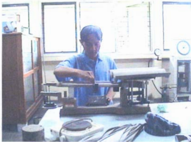
Penimbangan Benda Uji Genteng Beton
