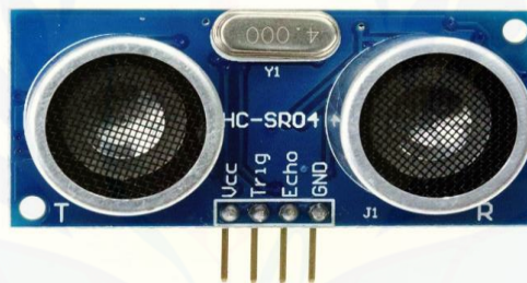
Gambar 2.2 Bentuk Fisik Sensor Ultrasonic HC-SR04
