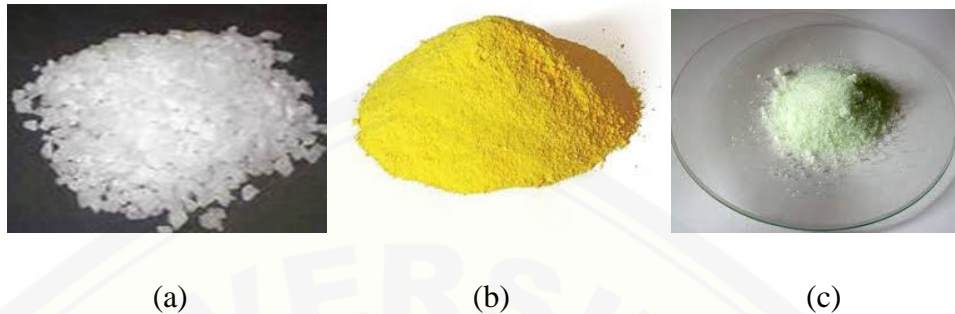
Gambar 2.2 Jenis-jenis koagulan kimia (a) granul Aluminium sulfat; (b) serbuk polialuminum klorida (c) serbuk besi sulfat (Anonim, 2014).
