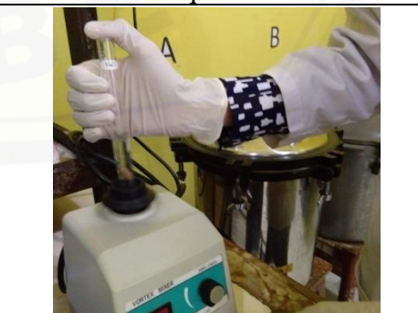
Mengisi 10 tabung reaksi dengan 9 ml aquades
