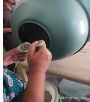
Gambar 3. Memasukkan benih dan bahan enkapsulasi kedalam mesin enkapsulator
