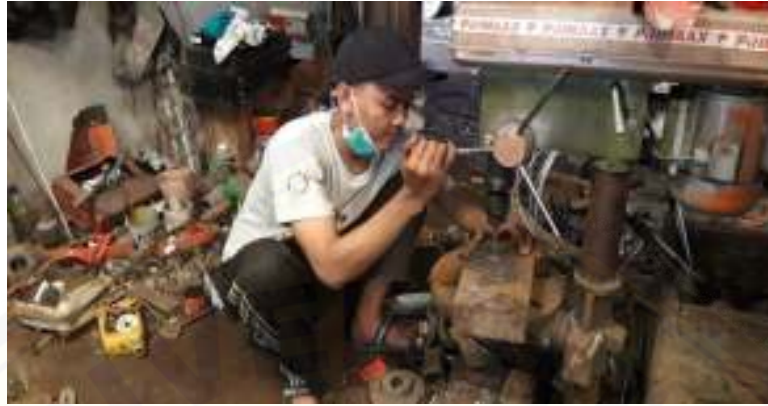
Gambar 3.7 Proses pengeboran besi plat duduan tail
