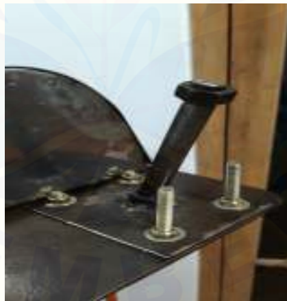
Gambar 3.11 Dudukan sistem tail pada dudukan generator.
