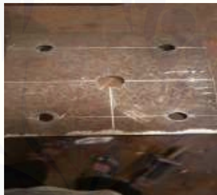
Gambar 3.8 Hasil pemotongan dan pengeboran besi plat duduan tail
