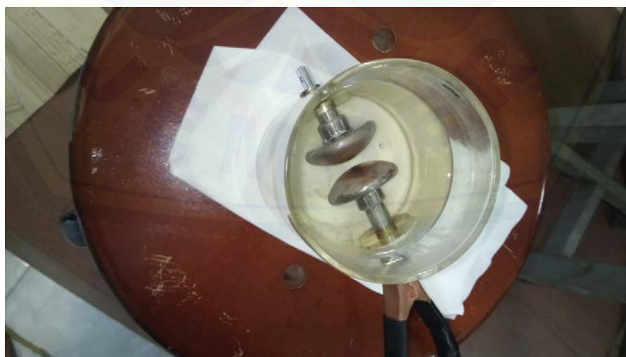
Gambar 2. Pengujian Breakdown Voltage sebelum ditembuskan
