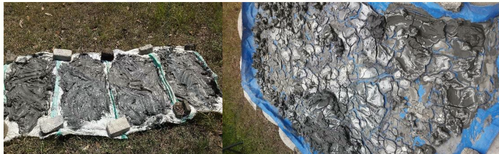
Gambar 3.2 Lumpur Dalam Tahap Pengeringan Matahari
