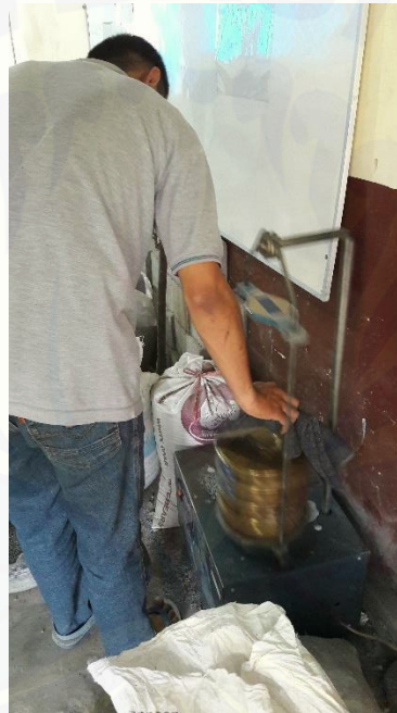
Gambar 3.6 Penyaringan Lusi Lolos Ukuran No. 200
