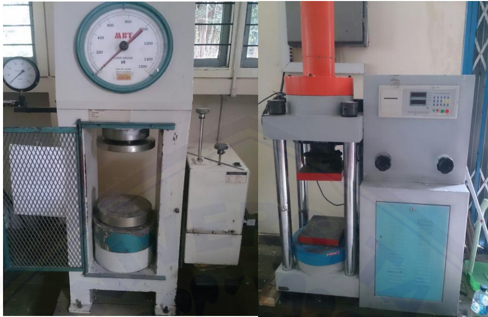
Gambar 3.9 Alat Uji Kuat Tekan Manual dan Digital
