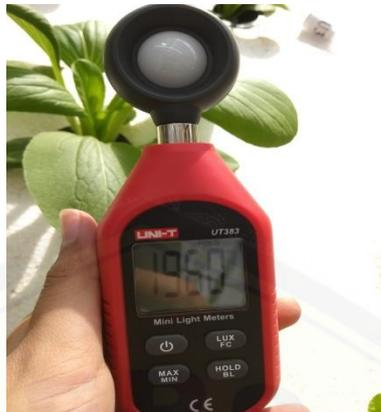
Gambar 3.6 Pengukuran Intensitas Cahaya
