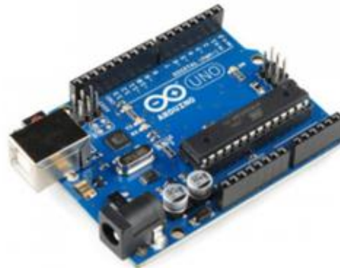
Gambar 2.2 Bentuk Fisik Arduino Uno R3 ( www.Arduino.cc )
