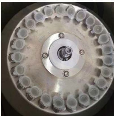
Gambar 4 :Tabung ependorf dimasukkan ke dalam sentrifugator untuk proses pemisahan campuran
