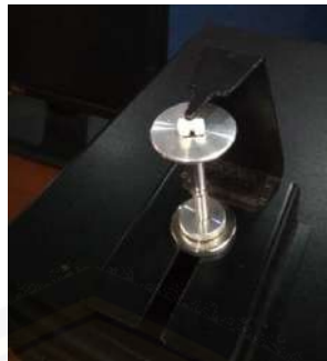
Gambar 3.9. Posisi sampel yang diletakkan pada holder (dokumentasi pribadi,2018).
