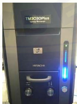
Gambar 12: Sampel yang telah diatur pada holder dimasukkan pada tabung SEM untuk dianalisa
