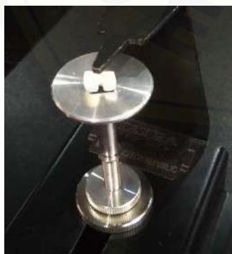
Gambar 11: Mengatur posisi sampel pada holder untuk dianalisa menggunakan SEM
