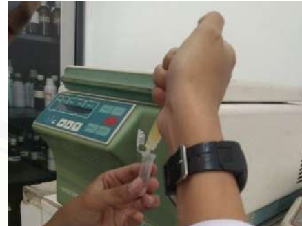
Gambar 2: Buah nanas dan buffer fosfat telah dihomogenisasi dengan perbandingan 1:1 dimasukkan ke dalam tabung ependorf 2 ml
