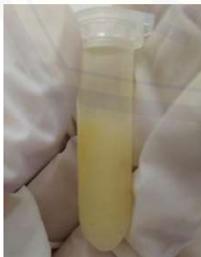
Gambar 5: Tabung ependorf yang telah dilakukan sentrifugasi. Nampak terbentuk supernatan dan endapan. Supernatan kemudian dipisahkan dari endapannya
