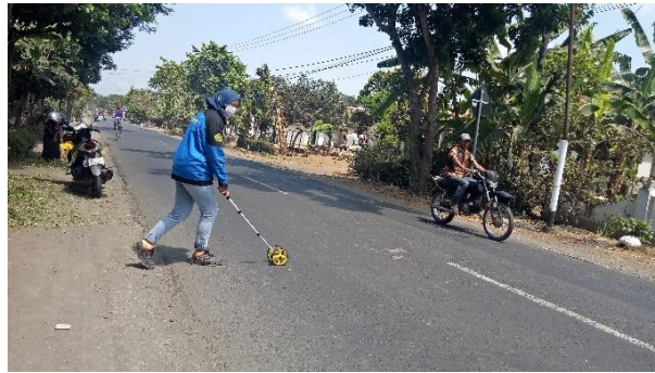
Gambar 1. Pengukuran jalan menggunakan alat working distance sumber : Dokumentasi Pribadi
