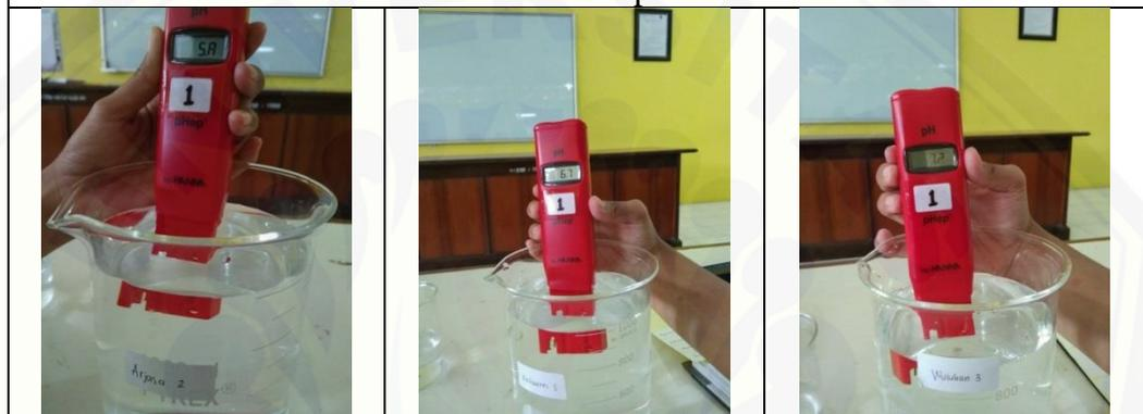
Gambar 13. Pengukuran pH
