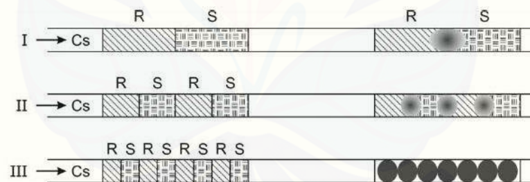
Gambar 2.3 Multi-commutation bentuk model aliran sampel dan reagen. Cs: larutan carrier; R: larutan reagen; S: larutan sampel. Simbol lingkaran hitam menunjukkan bahwa sampel dan reagen mengalami pencampuran (Sumber: Lavorante dkk., 2007)
