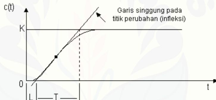
Gambar 2.9 Proses Desain Penentuan Parameter L dan T (Sumber : Bachri, 2004)
