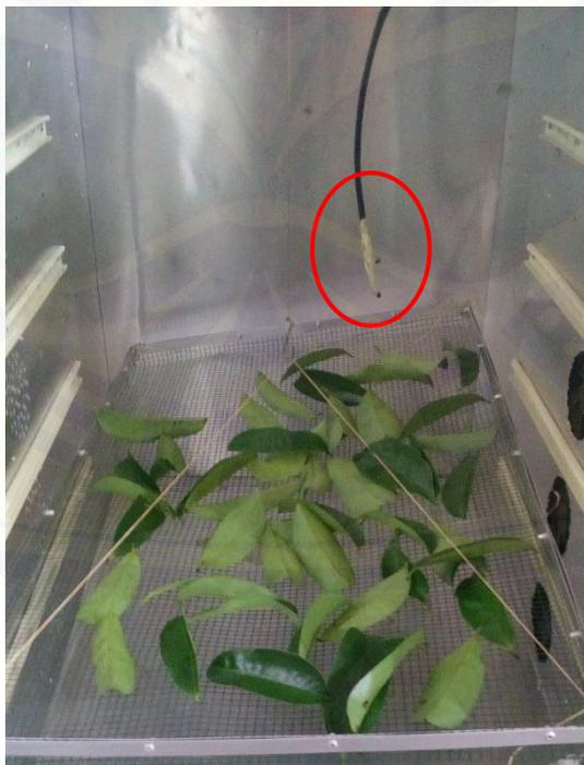
Gambar Pemasangan Sensor LM35
