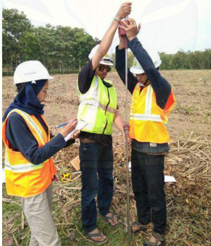
Dokumentasi Uji DCPT
