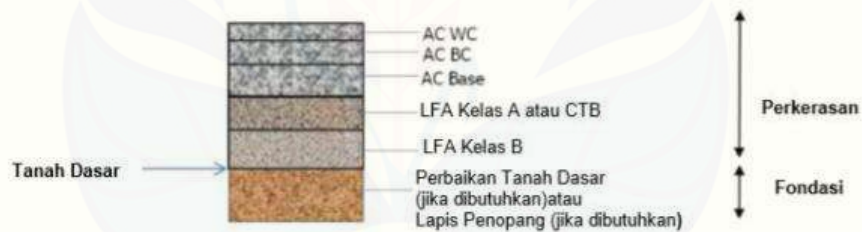
Struktur Perkerasan Lentur pada Galian
