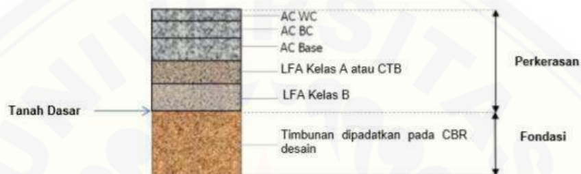
Struktur Perkerasan Lentur pada Timbunan
