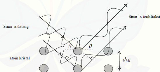
Gambar 2.5 Diagram sinar X datang dan terdifraksi oleh atom-atom kristal (Budi, 2011)
