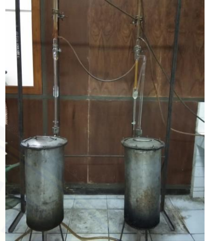
Proses destilasi minyak sereh wangi
