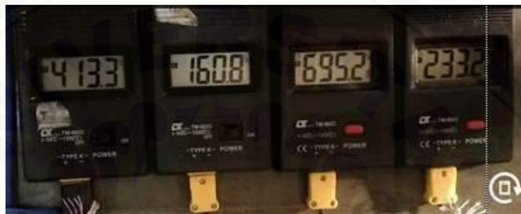
Gambar C.28 Temperatur api percobaan ke-3 bahan bakar biosolar
