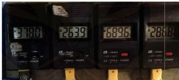
Gambar C.53 Temperatur api percobaan ke-3 bahan bakar biosolar
