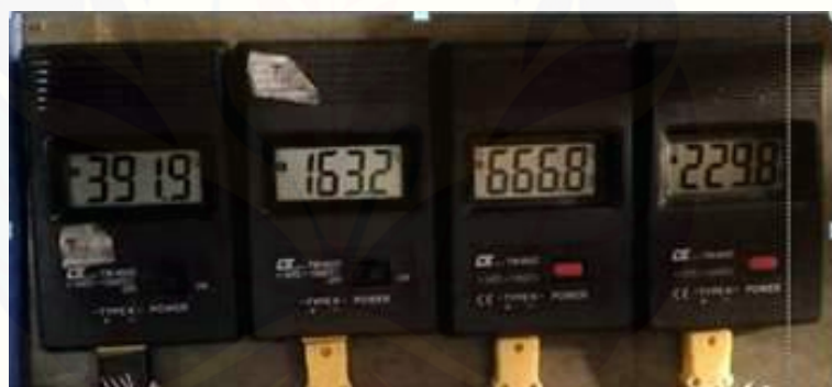
Gambar C.29 Temperatur api percobaan ke-4 bahan bakar biosolar
