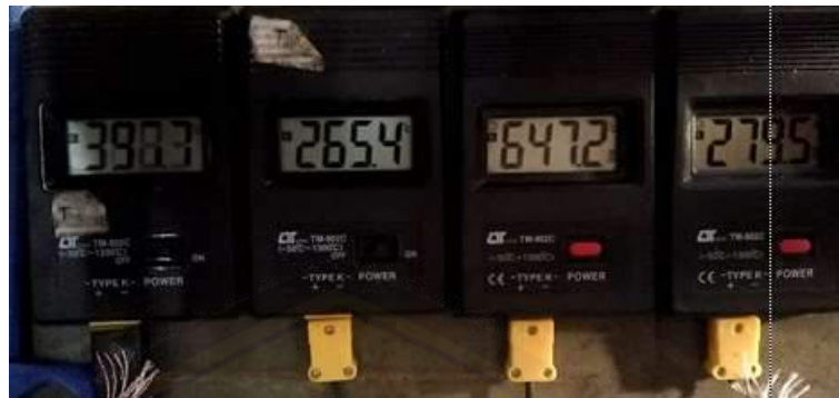
Gambar C.51 Temperatur api percobaan ke-1 bahan bakar biosolar
