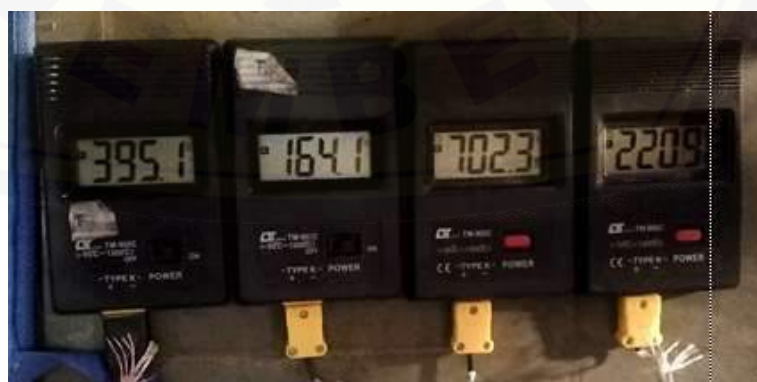
Gambar C.30 Temperatur api percobaan ke-5 bahan bakar biosolar
