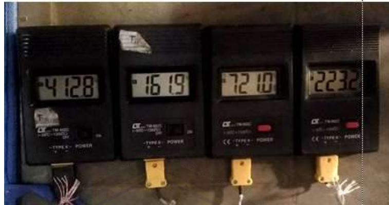
Gambar C.27 Temperatur api percobaan ke-2 bahan bakar biosolar
