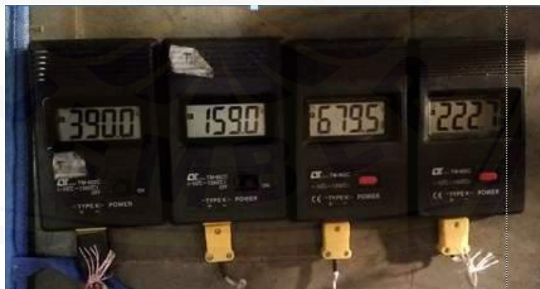
Gambar C.26 Temperatur api percobaan ke-1 bahan bakar biosolar
