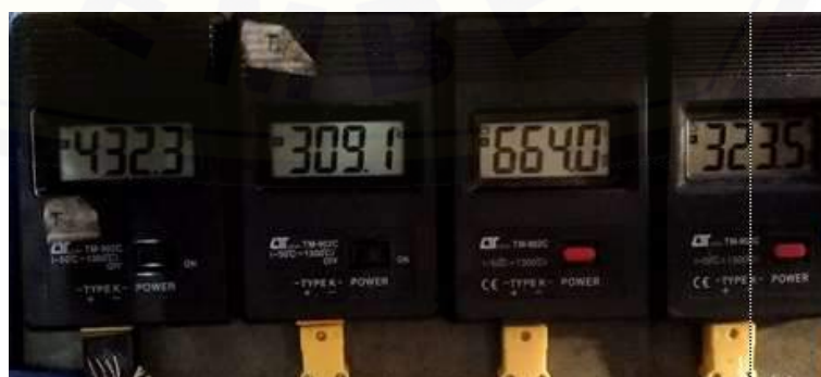
Gambar C. 54 Temperatur api percobaan ke-4 bahan bakar biosolar
