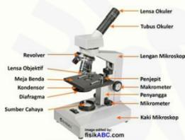
Pada gambar di atas ditunjukkan bagian-bagian mikroskop. Bagian mana yang menunjukkan bagian-bagian mekanik dari mikroskop...
