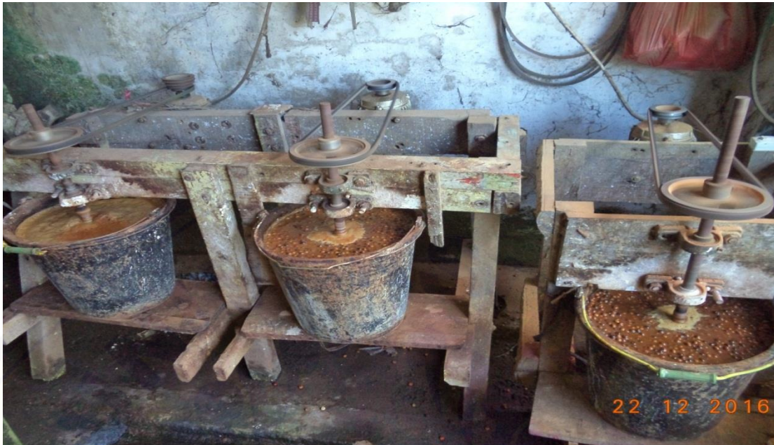
Gambar F.11 Pewarnaan Butiran Biji Tasbih dengan Cara Modern Menggunakan Alat yang telah Dimodifikasi Sendiri Oleh Pengrajin
