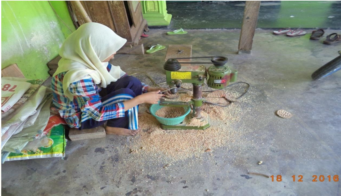
Gambar F.7 Proses Plong untuk Menghasilkan Butiran Biji Tasbih
