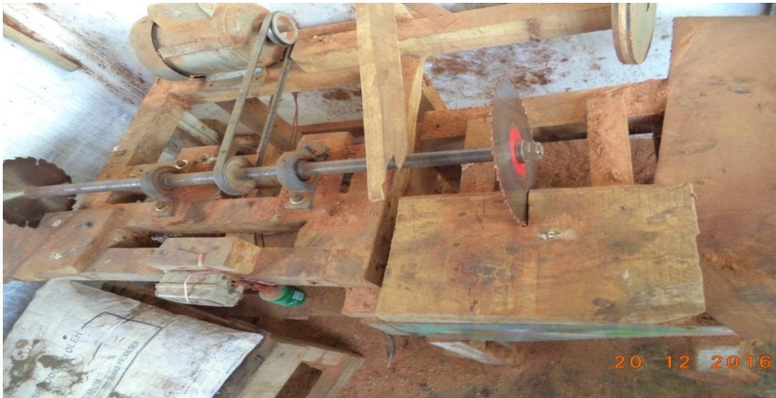
Gambar F.25 Alat Untuk Mmotong Kayu Kelapa Sesuai Ukuran Entong, Sutil, Sendok dan lainn
