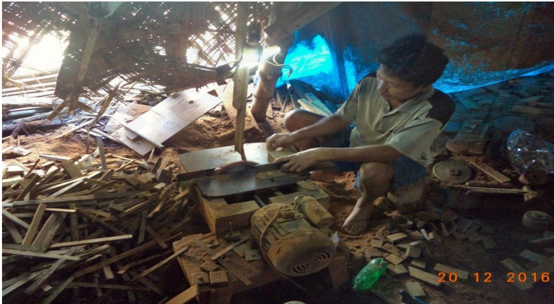
Gambar F.19 Kayu Dipotong Sesuai Ukuran Badan dan Tutup Tempat Merica
