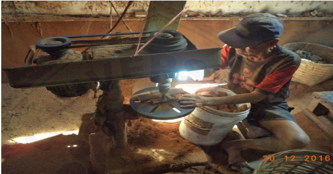
Gambar F.20 Kayu yang Telah Dipotong Dilubangi
