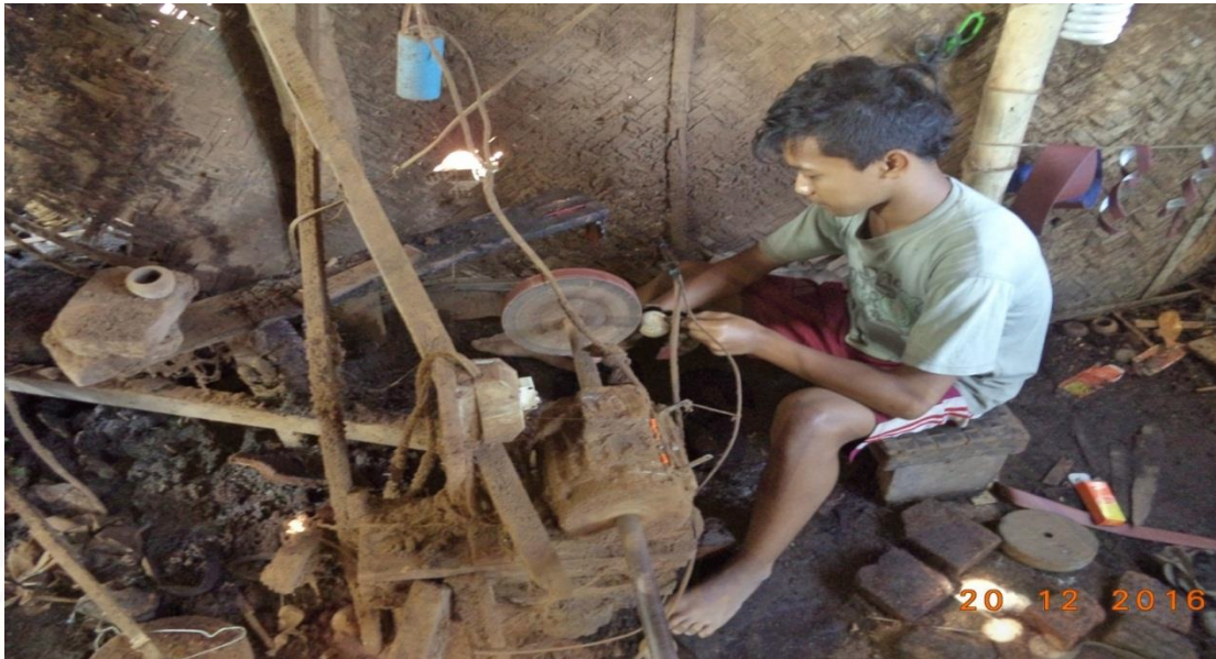
Gambar F.22 Kayu Berbentuk Balok Dihaluskan Agar Menjadi Silinder
