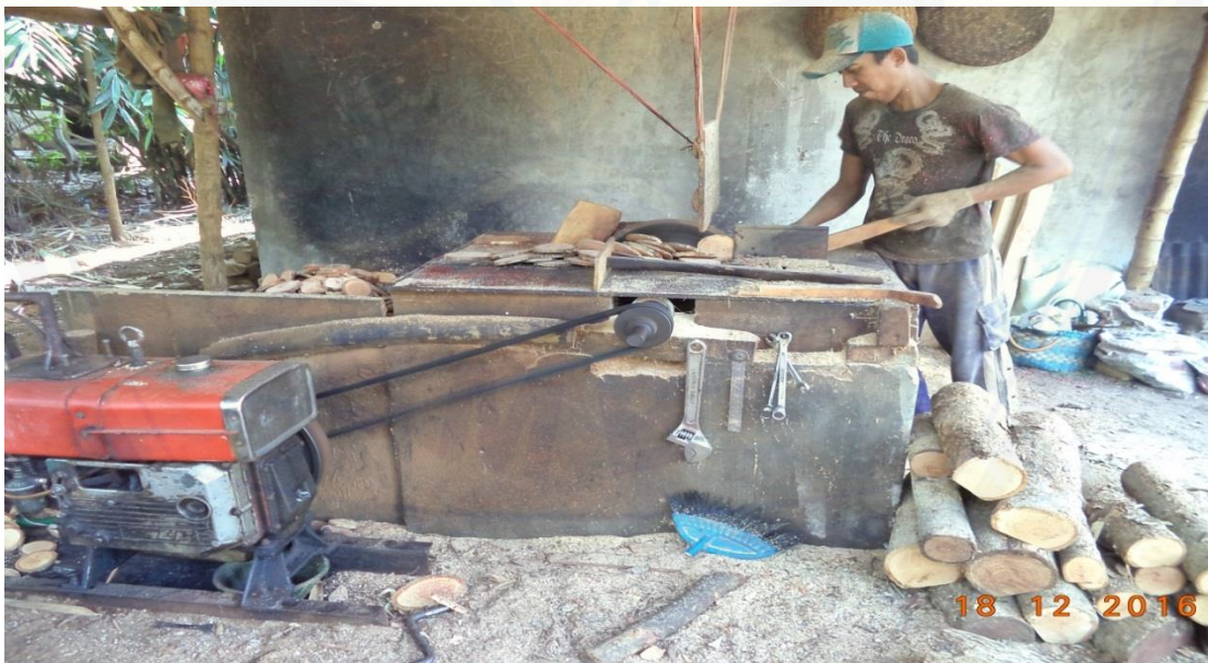
Gambar F.4 Langkah Awal Pembuatan Tasbih dengan Memotong Kayu Menjadi Lempengan Bulat
