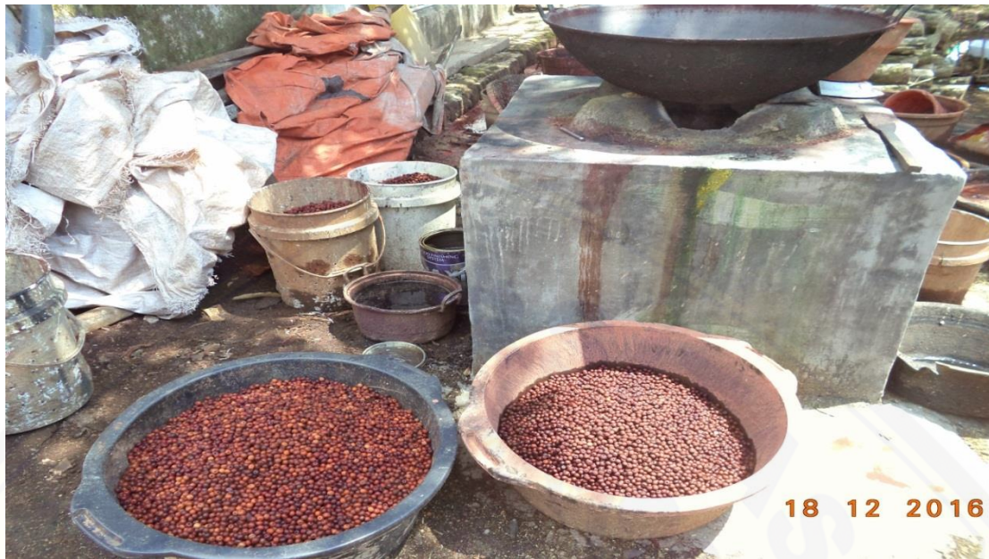
Gambar F.9 Pewarnaan Butiran Biji Tasbih dengan Cara Tradisional Melalui Proses Pemasakan
