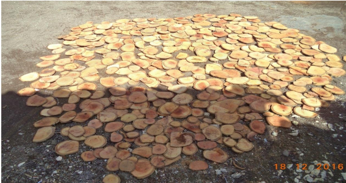
Gambar F.5 Menjemur Lempengan Kayu agar Kadar Air Menurun
