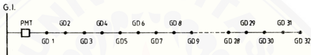
Gambar 2.3 Sistem Jaringan Radial (Sumber: SPLN 59, 1985)
