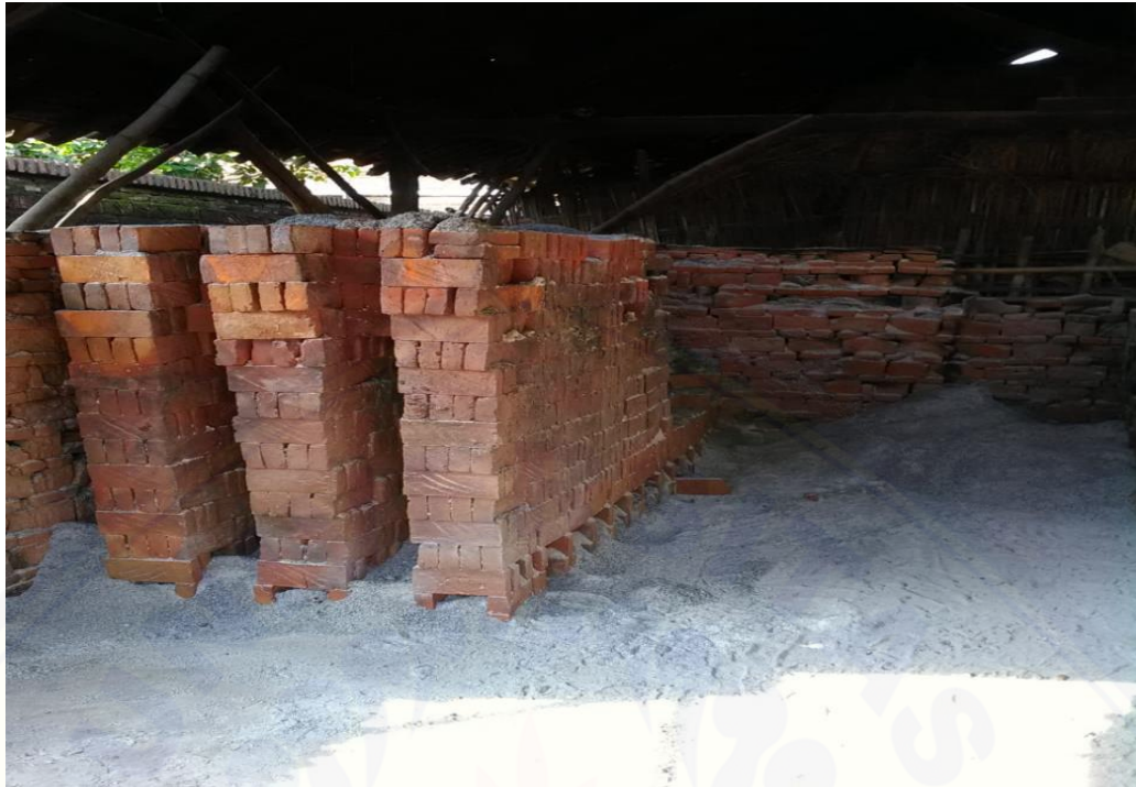
Gambar 7. Pembongkaran setelah dibakar
