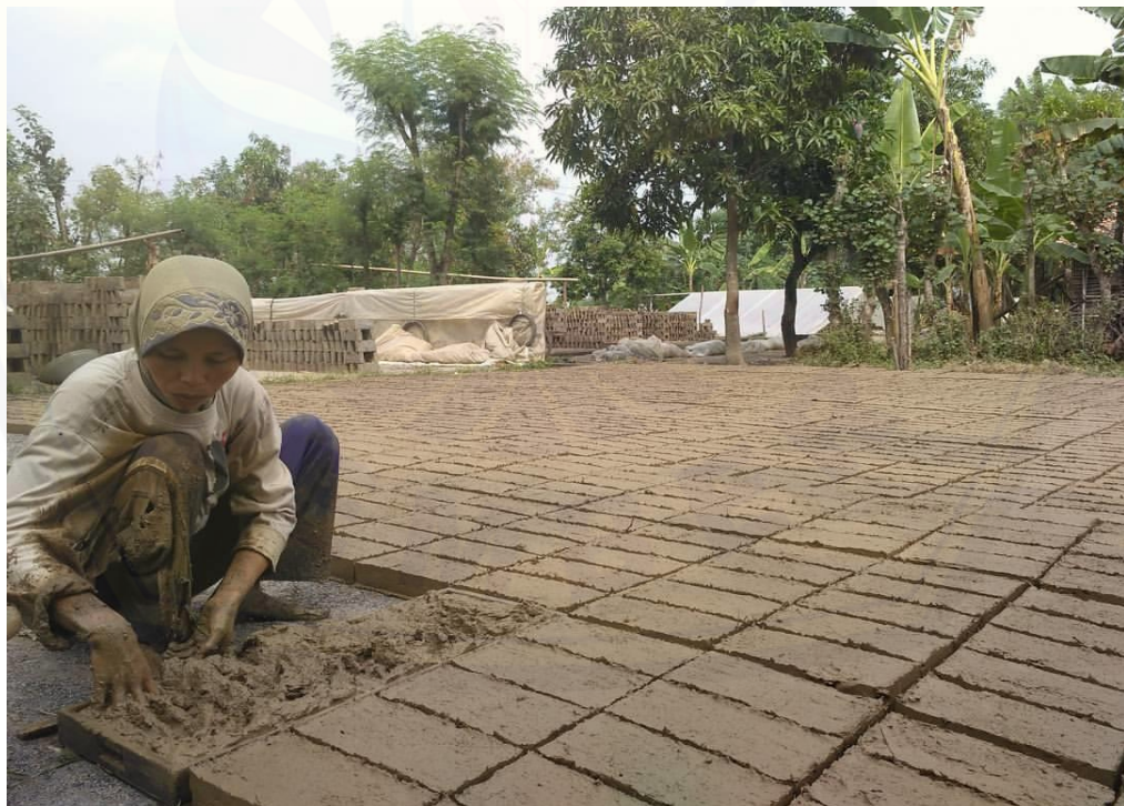
Gambar 4. Proses pencetakan batu bata
