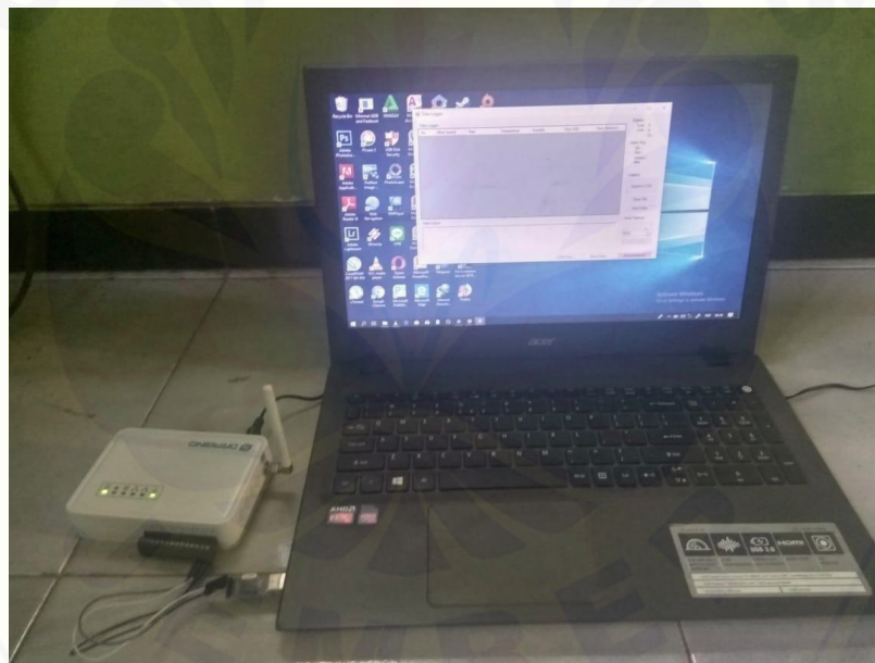
Gambar 3.5 Gateway Dragino LG-01 Terhubung dengan Laptop
