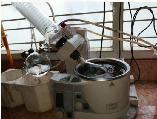
7. Memekatkan hasil maserat menggunakan rotary evaporator
