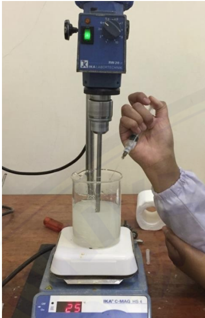
Campuran obat, polimer dan pelarut ditetaskan ke dalam fase eksternal berupa parafin likuid dan span 80
