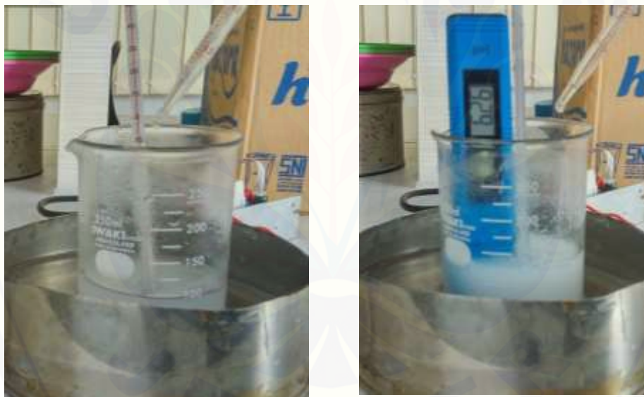
Gambar C.6 Proses pencampuran larutan katalis basa NaOH + PEG kedalam larutan prekursor ZAD dengan cara ditetaskan (titrasi) dan sekaligus mengukur pH yang dihasilkan.
