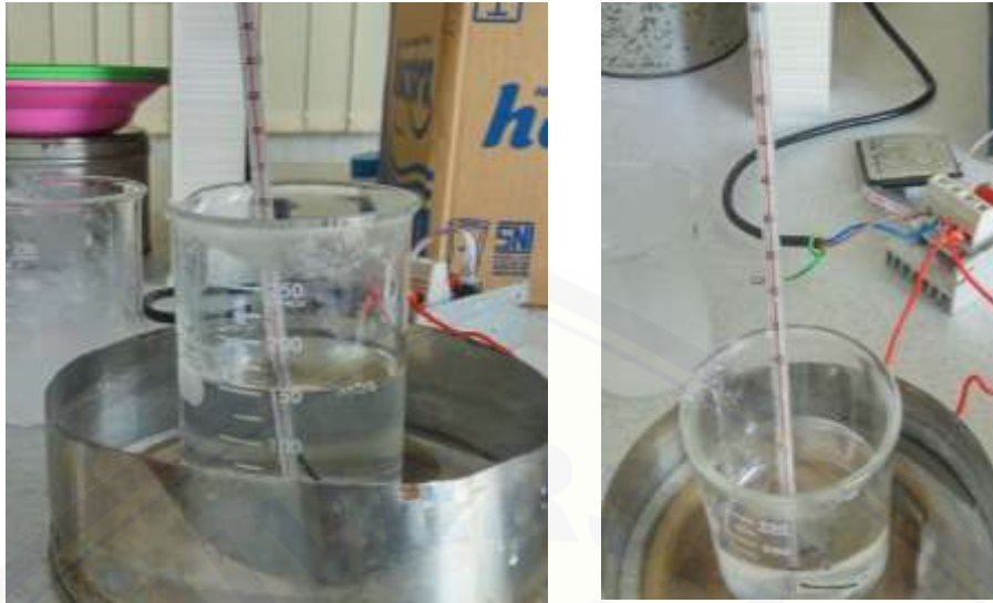
Gambar C.5 Proses pencampuran larutan katalis basa NaOH dengan larutan PEG.
